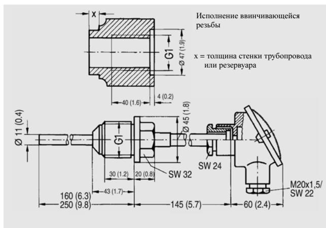
Ввинчивающийся термометр сопротивления высокого давления с соединительной головкой и консолью, размеры в мм (дюймах)
