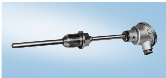
Ввинчивающийся термометр сопротивления высокого давления с соединительной головкой и консолью подходит для диапазона температур -50 ... +600 °C и может поставляться также со встроенным измерительным преобразователем температуры.
