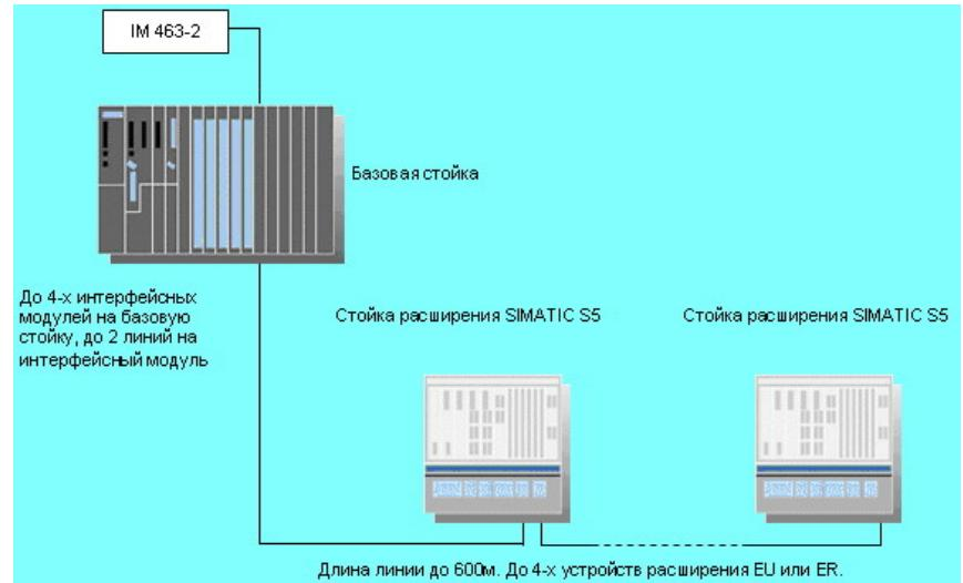
мальное расстояние между базовой стойкой и последней стойкой расширения не должно превышать 600м.
